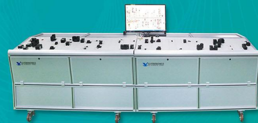
气动式线束测试台
